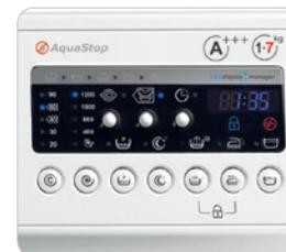
Панель управления с сегментным дисплеем и светодиодной индикацией
