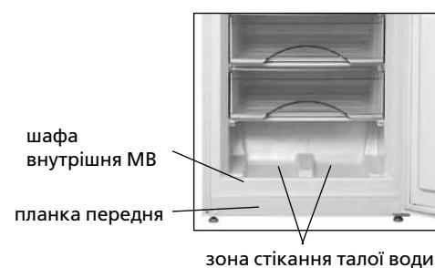
Рисунок 7 – Збір талої води з MB
